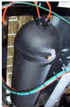
Neuer Druckluftbehälter eingebaut im Schmitz-Cargobull Trailer New Pressure Vessel at Schmitz-Cargobull trailer
